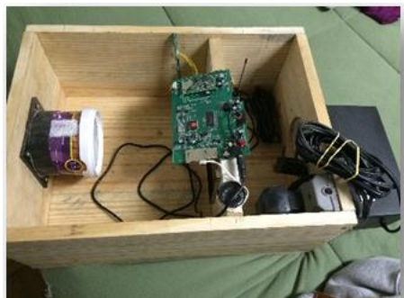
Figura 1 - Primeiro protótipo do projetor de imagens Fonte: Realizado pelas autoras
