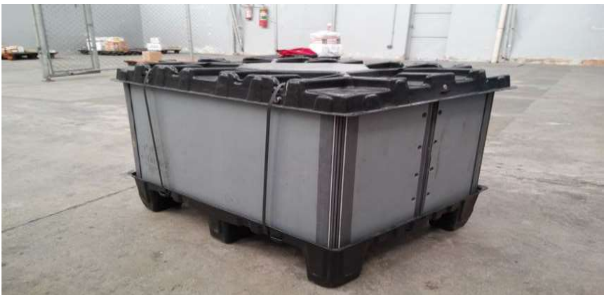
Figura 2: Exemplo de container box no tamanho 800mm x 600mm x 680mm. Ideal para o transporte de caixas iguais ou menores que 400mm x 300 mm x 340 mm. Peso bruto da embalagem sem carga é de 11,5 kg.
