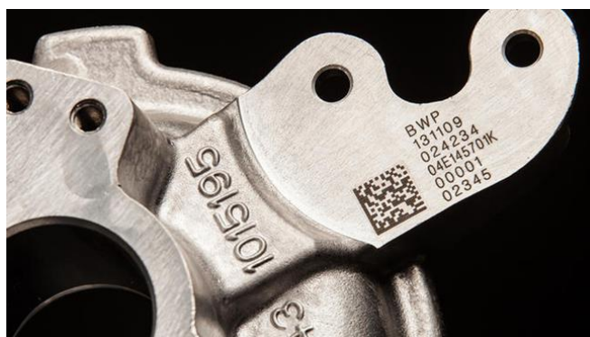
Figura 5: Exemplo de impressão realizado sobre metal proveniente da impressora a laser
