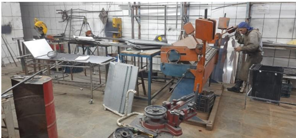
Figura 10 - Corte de Tubos – Produção de Componentes da Estrutura
