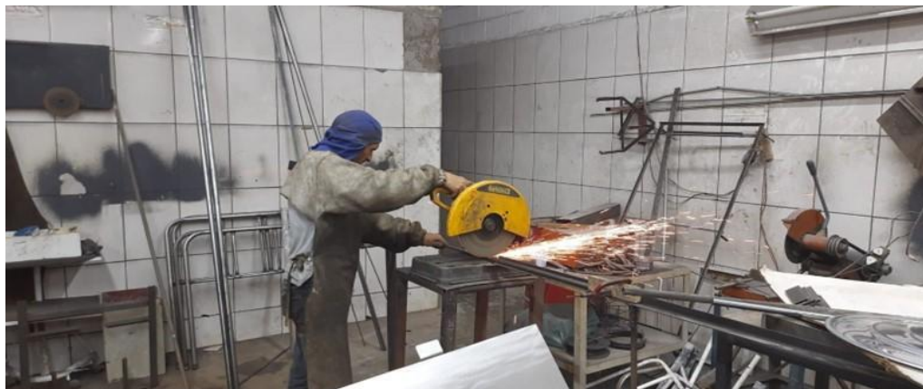
Figura 10 - Corte de Tubos – Produção de Componentes da Estrutura
